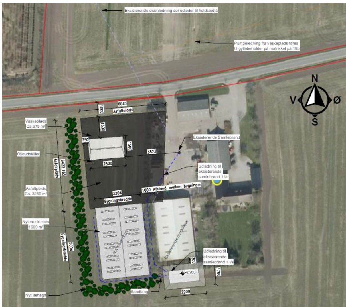
Figur 1: Placering af affaldsforbrændingsslagge. Der lægges slagge ud under det mørke areal med den overdækkede vaskeplads samt under maskinhuset mod sydvest.
